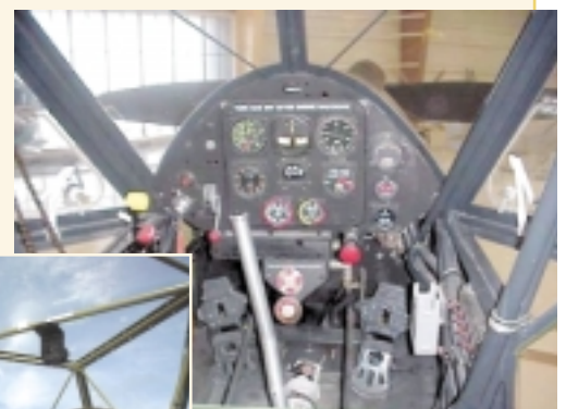
Particolare della cabina dell' ULM Slepcev (a lato) e dell'originale (sopra): la visibilità è ottima in quasi tutte le direzioni anche se non si gode propriamente di libertà di movimento...
