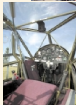
Particolare della cabina dell' ULM Slepcev (a lato) e dell'originale (sopra): la visibilità è ottima in quasi tutte le direzioni anche se non si gode propriamente di libertà di movimento...
