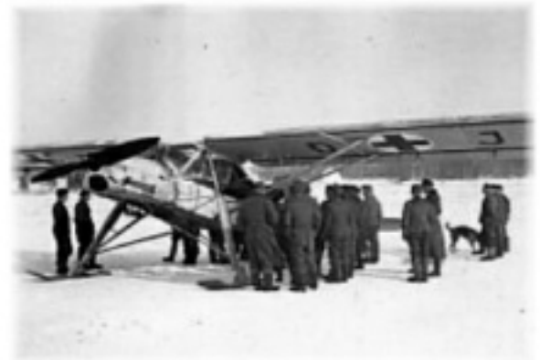
Fieseler in versione trasporto feriti sul fronte orientale con colorazione invernale e pattini per terreni innevati
